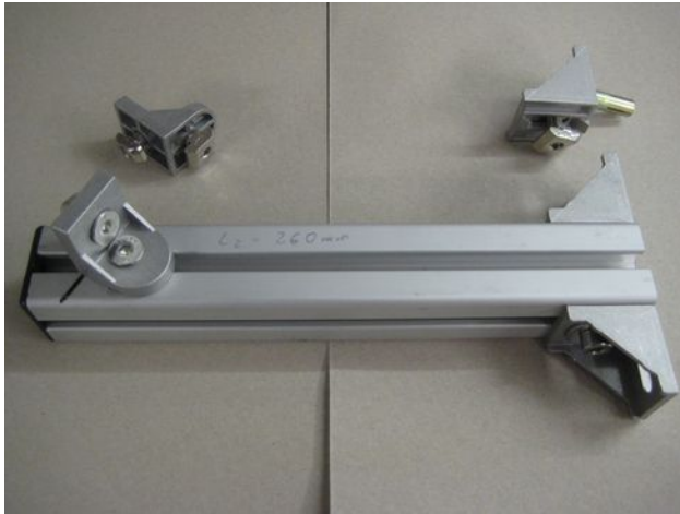
Konstruktionsprofil 40x40 mit 8mm-Nut als horizontale Stütze
